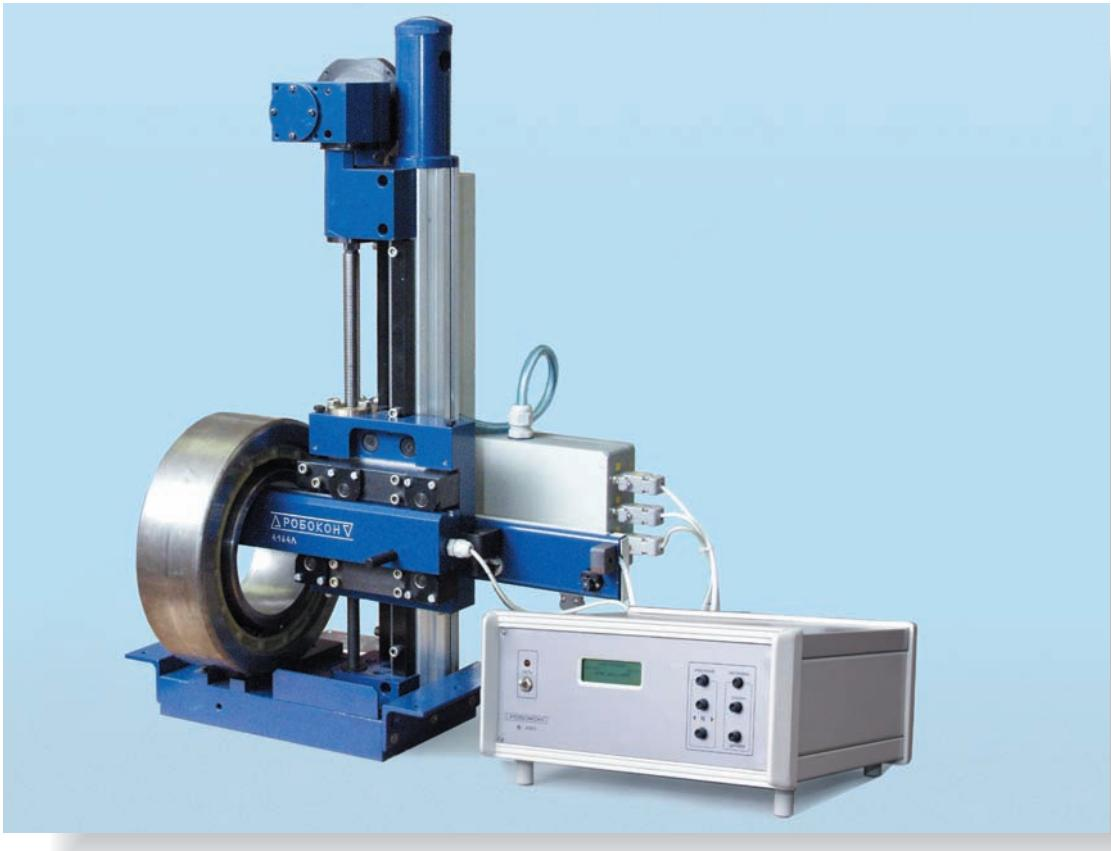
Прибор модели 4164Л предназначен для измерения радиального зазора в радиальных подшипниках любого типа, практически без переналадки для перехода к измерению от одного типа - размера подшипника к другому.
