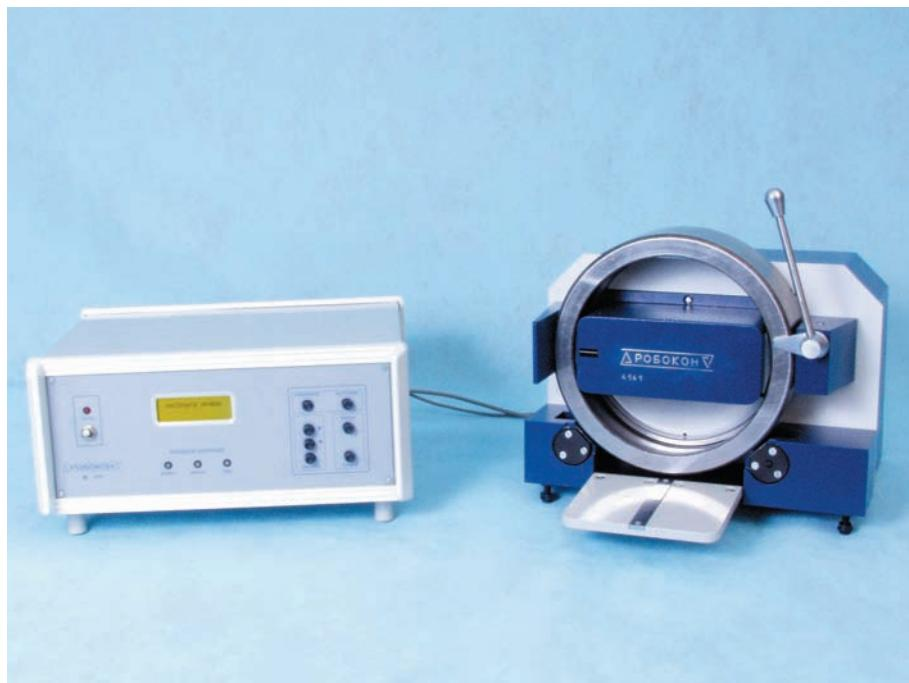
Прибор модели 4161 предназначен для контроля и сортировки наружных колец буксовых подшипников на размерные группы по внутреннему диаметру и ширине дорожки качения (расстоянию между буртами) для последующей селективной сборки.
