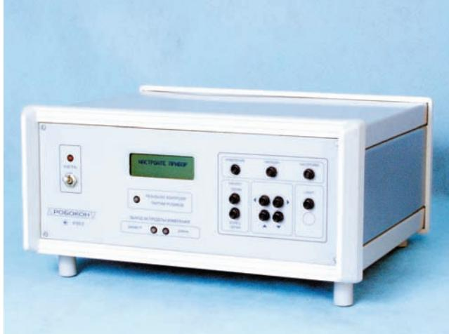
Прибор модели 4155 предназначен для контроля линейных размеров роликов подшипников и сортировки их на размерные группы для последующей селективной сборки.
