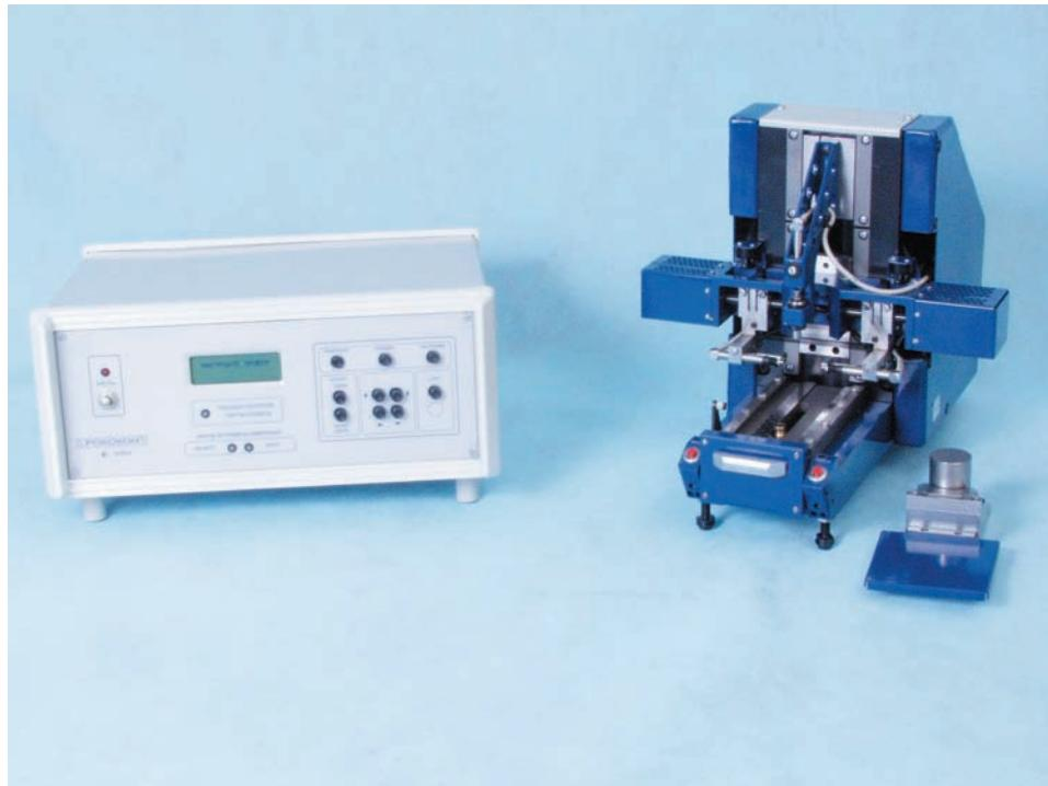
Прибор модели 4155Л универсальный полуавтоматический, предназначен для подбора и сортировки роликов подшипников различного типа (цилиндрических, бочкообразных и бомбинированных).
