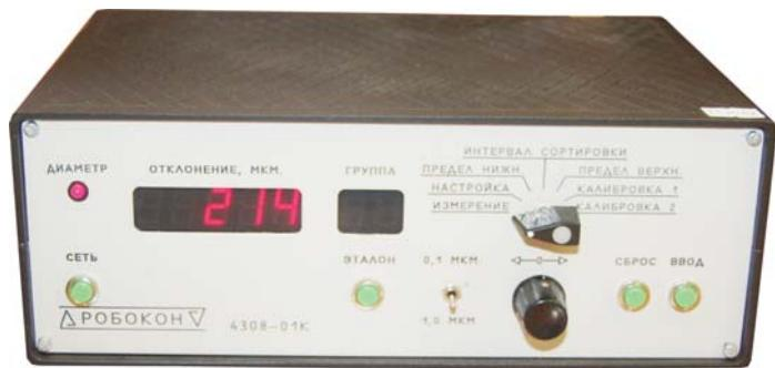
Прибор модели ПР8 предназначен для измерения диаметра отверстия в деталях типа втулки плунжера и сортировки их на размерные группы.
