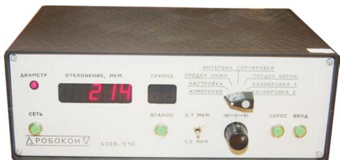
Прибор модели ПР7 предназначен для измерения диаметра отверстия в деталях типа втулки плунжера и сортировки их на размерные группы.
