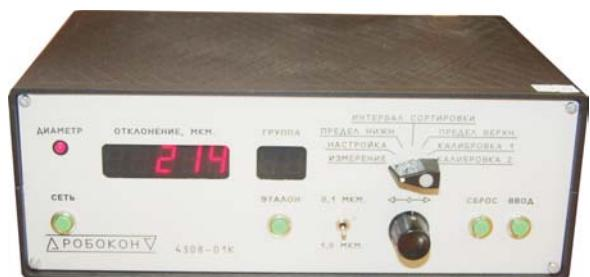
Прибор модели ПРЗМ предназначен для измерения диаметра отверстия втулок плунжера секций распределительных насосов и сортировки их на размерные группы.
