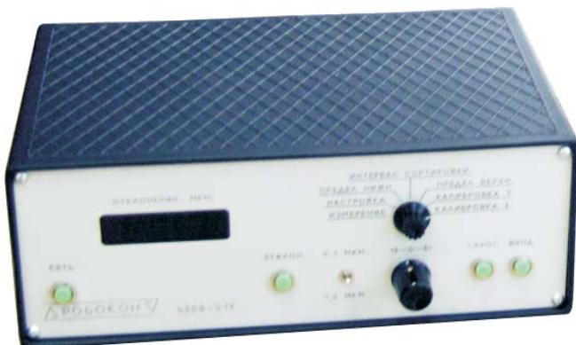
Прибор модели РПА 4М предназначен для измерения отклонения от прямолинейности оси отверстия в деталях типа втулки плунжера.
