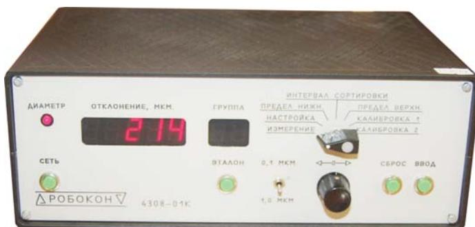
Прибор модели ПР5М-1 предназначен для измерения диаметра и автоматического контроля отклонения профиля продольного сечения (например, конусообразности, бочкообразности или седлообразности) отверстия в деталях типа корпуса распылителя, втулки плунжера, ролика толкателя и др. деталей топливной аппаратуры и сортировки деталей на размерные группы.
