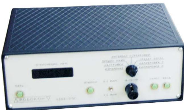
Приборы моделей РПА 5 и РПА 6 предназначены для измерения биения запорного конуса корпуса распылителя относительно его центрального отверстия.
